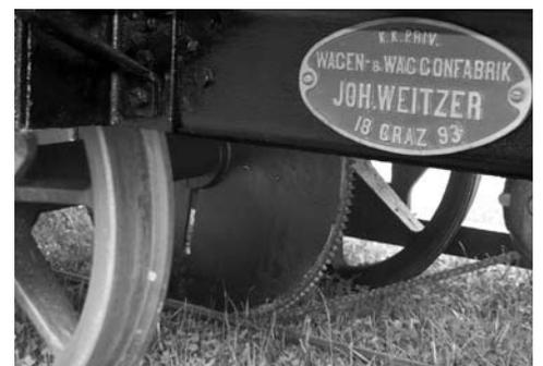
Kettenradantrieb mittels Hubstaplermotor
